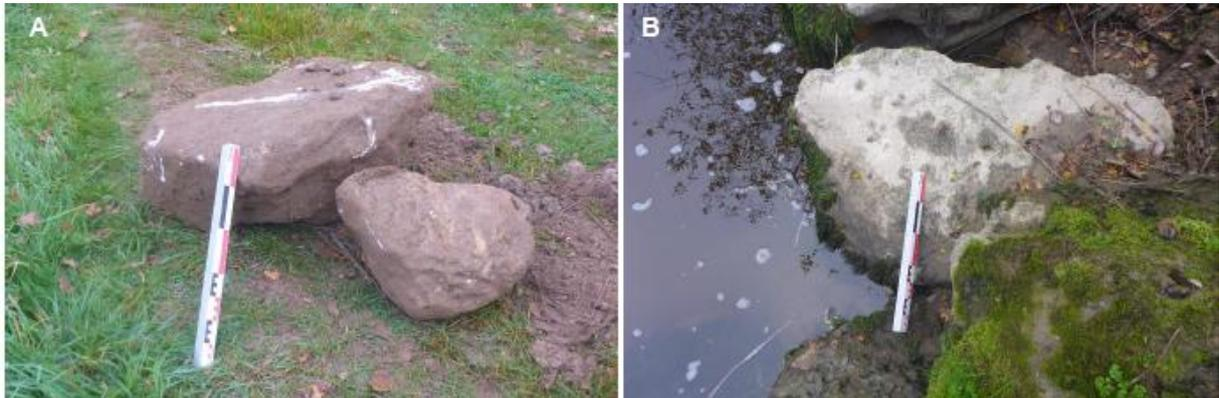
Caractérisation des dimensions des blocs constituant l'enrochement. En A : Blocs situés sur les couches les plus hautes. En B : Blocs situés à la base de l'enrochement.
