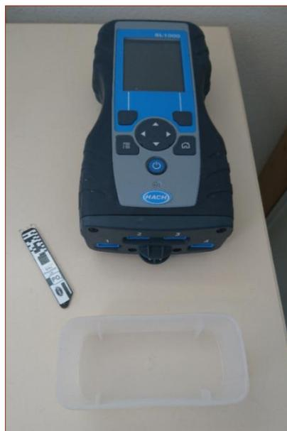
FIGURE 3: APPAREIL DE MESURE HACH® SL1000 ET CHEMKEY
