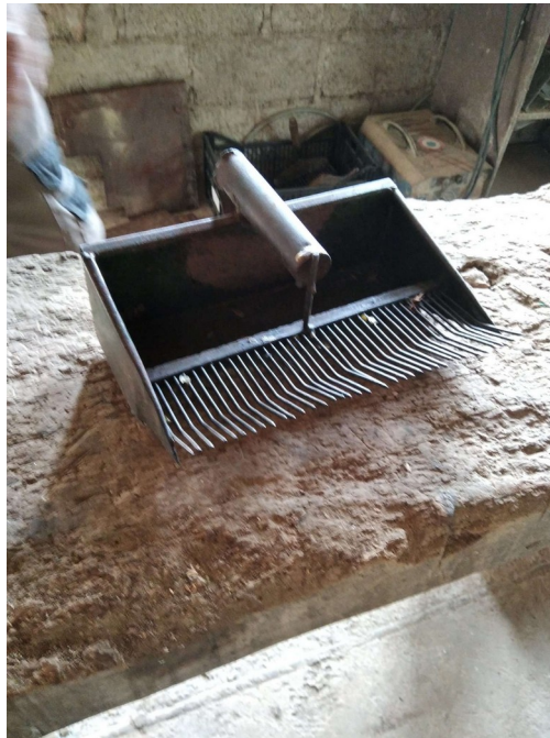
Figure 17 - Peigne à caisse en métal (Monts du Forez, Loire et Puy de Dôme). Il s'utilise avec les deux mains. Il a progressivement été remplacé par le peigne râteau, au cours des années 60.
