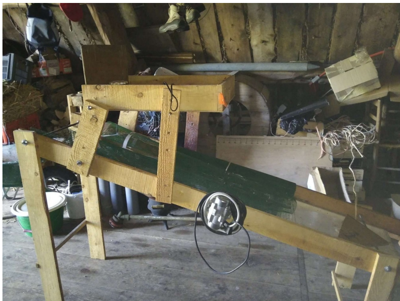
Figure 32 - Trieuse à myrtilles artisanale (Monts du Forez, Puy de Dôme)
