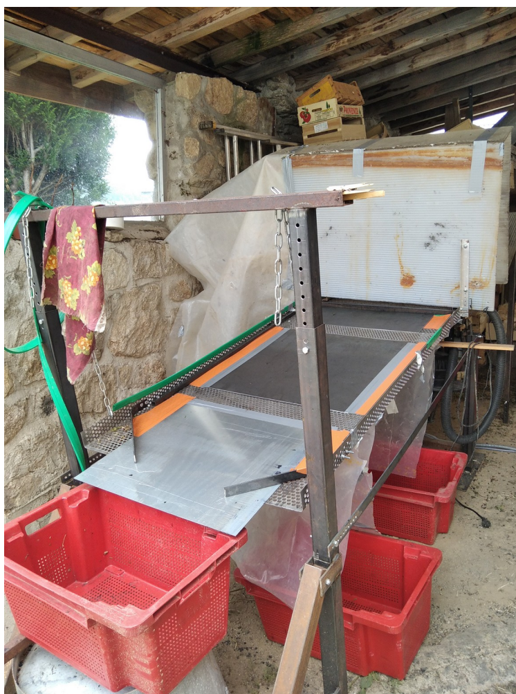
Figure 33 - Trieuse à myrtilles avec calibrage (Monts du Forez, Loire)
