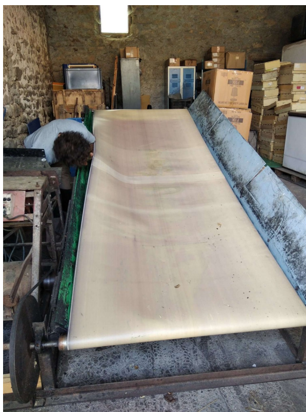
Figure 30 - Trieuse avec tapis remontant à grande vitesse (Monts du Forez, Loire)
