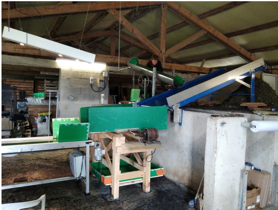
Figure 34 - Trieuse avec tapis remontant à grande vitesse (Monts du Forez, Loire)
