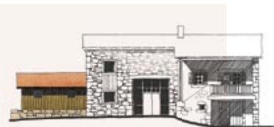
Sur le même principe d'extension latérale, le garage créé ici abrite deux voitures. Les portes d'accès sont en pignon. Une structure et un bardage bois reposent sur un mur de soubassement en pierre qui marque l'horizontalité dans la pente.
