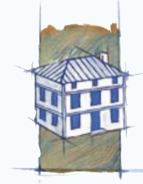
La maison de maître, monobloc à deux étages sur rez-de-chaussée, couvert par une toiture à quatre pans.
