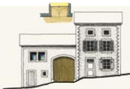
Placer un chassis en retrait de l'ouverture existante de la grange permet de conserver les portes et donc la possibilité de clore facilement l'extension. Les proportions de la nouvelle fenêtre de grange s'inspirent de la petite ouverture existante en rez-de-chaussée.
