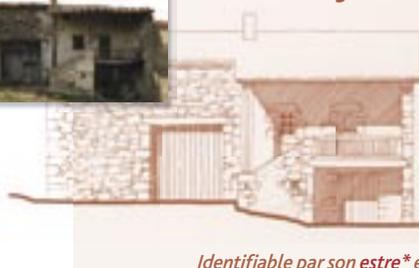
Identifiable par son **estre\*** et son auvent. Le logement est réduit au minimum, la solution la plus naturelle consiste à occuper le volume de la grange. L'ouverture de la porte de grange est réinterprétée au moyen d'un rythme de pleins
