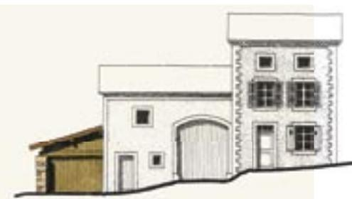
A une première extension dans un volume existant, peut s'ajouter une seconde intervention, consistant à créer un garage. Celui-ci peut être accolé en pignon. D'environ 3,50 m. de large, il abrite une voiture, et il est couvert par un toit monopente. La structure et le bardage sont en bois, le principe d'un pilier en pierre, ou d'un mur est repris en pignon.
