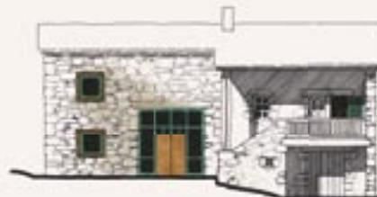
et de vides, tramé par une menuiserie qui peut être en bois ou en métal. Les nouvelles ouvertures de la grange seront d'un format différent. Le logement est faiblement éclairé : une fenêtre est jumelée à la porte d'entrée et s'inspire de l'ouverture existante. L'espace du rez-de-chaussée pourra être utilisé en garage, atelier, espace de rangement...
