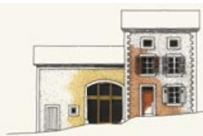
La reconversion de la porte de grange apporte ici la lumière nécessaire au confort de l'extension, en rez-de-chaussée et en étage. Malgré sa transformation, la porte de l'ancienne grange est toujours identifiable : la composition de la construction est respectée.
