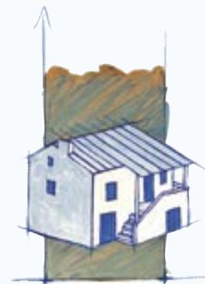
La maison de vigneron, maison bloc en hauteur, fréquente en centre bourg, superpose le logement et le cuvage. La structure verticale permet une utilisation rationnelle du terrain dans la structure groupée du village.
