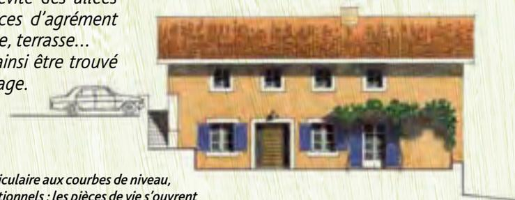
*Une implantation perpendiculaire aux courbes de niveau, inspirée des principes traditionnels : les pièces de vie s'ouvrent de plain-pied sur le terrain. Le garage est accessible en partie haute.*
