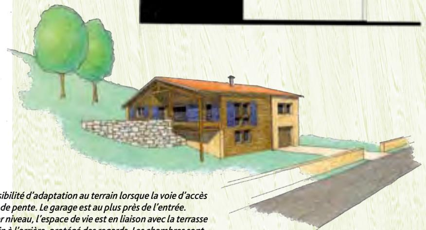
*Autre possibilité d'adaptation au terrain lorsque la voie d'accès est en bas de pente. Le garage est au plus près de l'entrée. Au premier niveau, l'espace de vie est en liaison avec la terrasse et le terrain à l'arrière, protégé des regards. Les chambres sont au rez de chaussée.*
