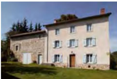
Toutes les surfaces de façade n'ont pas à être traitées de façon identique, malgré la continuité des volumes. Le logement sera ré-enduit, les dépendances agricoles seront généralement rejointoyées, ou pourront recevoir un enduit de teinte différente.
