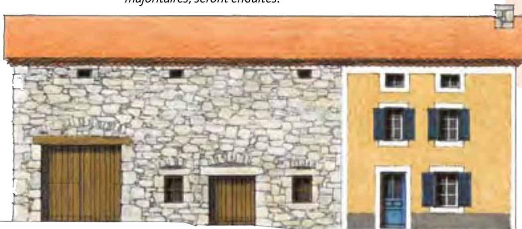
**La fonction de l'enduit est de dissimuler l'irrégularité de la maçonnerie et de la protéger contre les intempéries : pluie, vent, gel... L'enduit améliore sensiblement l'isolation et le confort du logement. Les dépendances sont rarement enduites en raison de leur superficie plus importante.**
