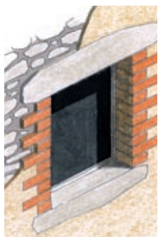
Les encadrements d'ouvertures, conçus en légère saillie sont destinés à bloquer l'enduit.
